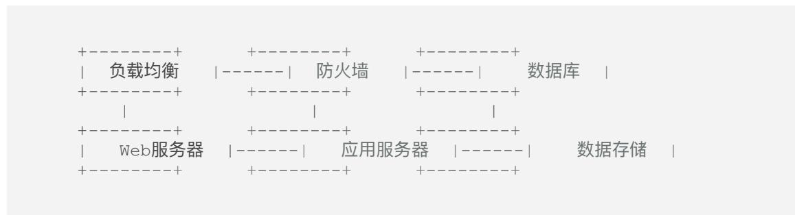
在这个示例中，负载均衡设备和防火墙实现了流量的负载均衡和网络安全，Web服务器和应用服务器实现了业务逻辑处理，数据库和数据存储实现了数据存储和备份，整个网络拓扑结构实现了高可用性和容错性。
